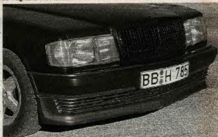
Kunststoffbeschichteter Kühlergrill in Wagenfarbe und tiefgezogener Frontspoiler, Kostenpunkt bei Hagmann 1100 Mark
