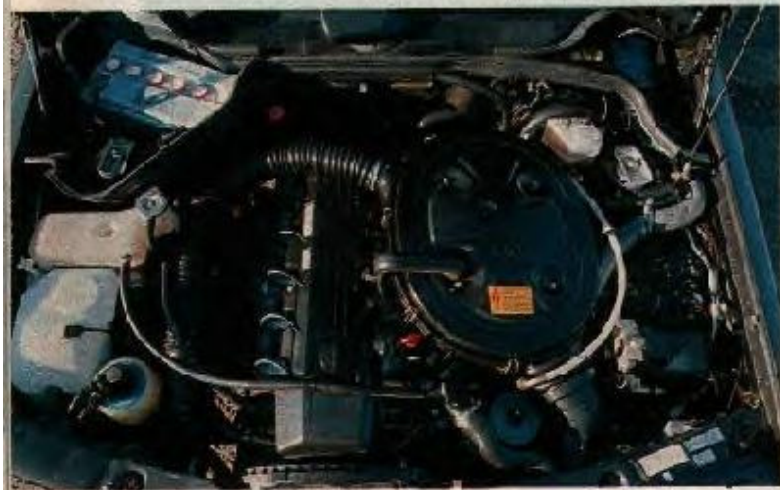
Etwas rau und nicht besonders drehfreudig. 3,2 Liter-Sechszylinder mit 234 PS im 190 E-AMG
